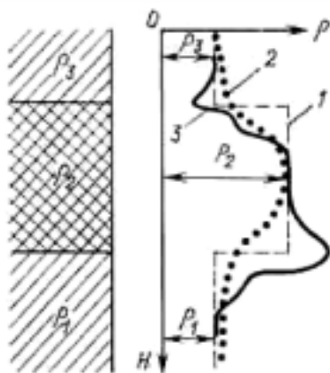
Рис. 7.8 Диаграммы удельного электрического сопротивления: истинного (1) и кажущегося для потенциал-зонда (2) и градиент-зонда (3) в пласте высокого сопротивления большой мощности
